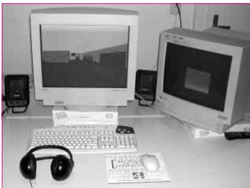
VERSUCHSANORDNUNG DER „SECONDARY TASK REACTION TIME MEASUREMENT“-STUDIE. DER LINKE MONITOR ZEIGT EIN VIRTUELLES MUSEUM. AUF DEM RECHTEN BILDSCHIRM SIEHT DER TEILNEHMER DER STUDIE GLEICHZEITIG EIN ROTES SIGNAL AUFLEUCHTEN, GLEICHZEITIG ERTÖNT EIN SIGNALTON. DARAUFIN SOLL ER SO SCHNELL WIE MÖGLICH EINEN KNOPF DRÜCKEN. DIE ZEIT, DIE ER/SIE DAFÜR BENÖTIGT, WIRD IN 1/1000-SEKUNDEN GEMESSEN UND VERRÄT ETWAS ÜBER DAS „PRESENCE“-ERLEBEN BEI DER WANDERUNG DURCH DAS VIRTUELLE MUSEUM.
